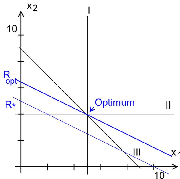
Abb. 11.7 - Verschiebung der Zielfunktion ins Optimum
